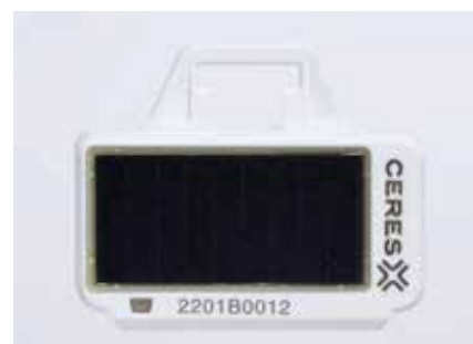
Рисунок 1. Ушная бирка фирмы CERES Tag со встроенным GPS
