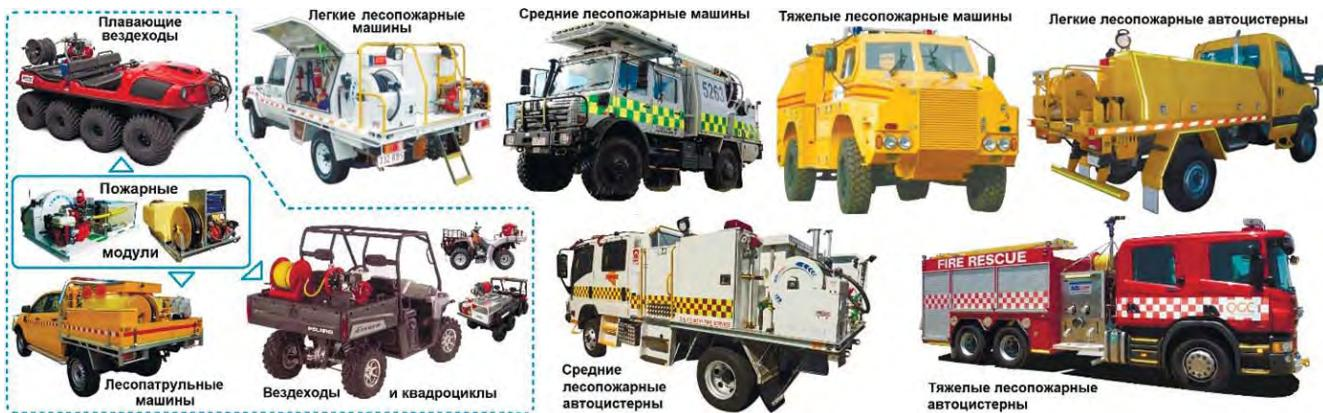
Спектр колесных машин для прямого тушения пожаров в природной среде водой и водными растворами (на примере Австралии). Пунктиром выделена группа легкой пожарной техники, применяемой преимущественно для патрулирования территории (квадроциклы, машины и легкие вездеходы) с емкостями для воды до 1 т
