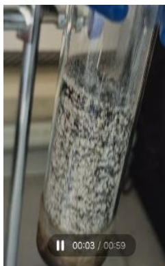
Рисунок 4 – Сорбционная колонна с композитом на основе диатомита и термообработанной рисовой шелухи
